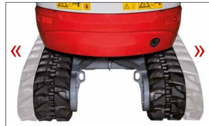
Tren de rodaje con ensanchamiento hidráulico de vía.
