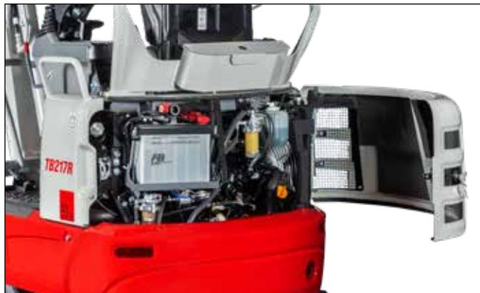
Motores con niveles bajos de emisión de gases y de ruido reducido con doble filtro de aire. Amplio compartimento del motor; capot del motor con apertura lateral.
