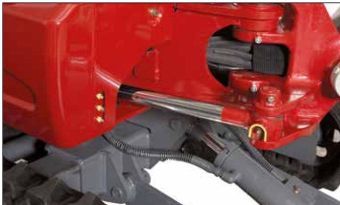
Robusto bloque de giro con latiguillos especialmente protegidos y giro de brazo hidráulico.
