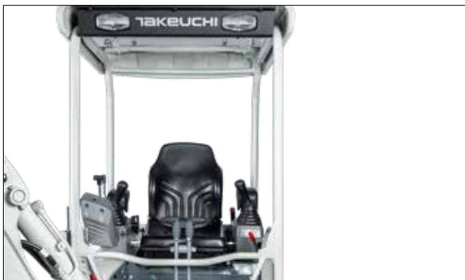
Techo de protección con ROPS (ISO12117), TOPS (ISO12117-2), OPG (ISO10262 nivel 1) y asiento de confort (resistente a la intemperie) con cinturón de seguridad.
