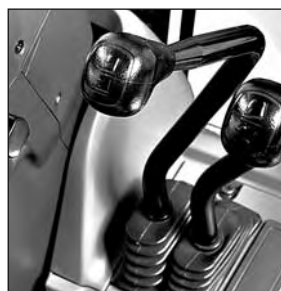
Palancas hidráulicas instaladas en el salpicadero
