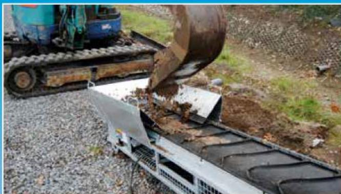
Una tolva más grande permite cargarla con una mini-excavadora y reduce el derramamiento de material.
