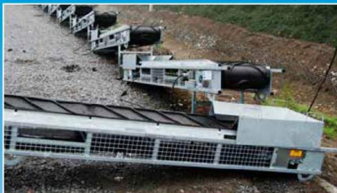
Se pueden unir varias cintas transportadoras entre sí, funcionando mediante una única fuente de alimentación utilizando los cables de conexión.
