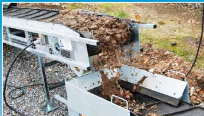
Los soportes móviles le permiten colocar cada cinta transportadora exactamente encima de la siguiente.
