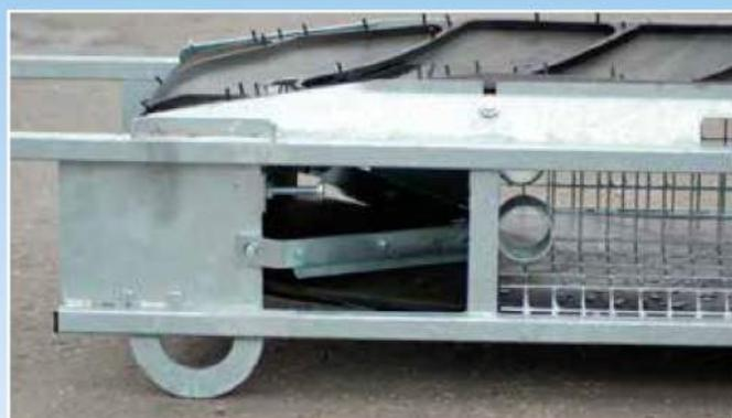
Una sencilla raedora de cinta mantiene limpia la cinta. Se proveen aberturas para el montaje y tubos de andamiaje y la cinta se puede ajustar fácilmente.
