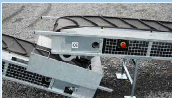
¡La seguridad es una prioridad para Etramo! Cada cinta transportadora viene equipada con 2 botones de parada de emergencia, uno a cada lado de la cinta. Al pulsar cualquier parada de emergencia en cualquier cinta transportadora que forme parte de la serie detendrá todas las cintas transportadoras en el circuito de la serie.
