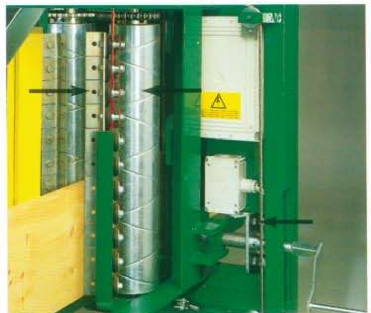
Cilindros de arrastre regulados por medio de soportes de goma, rasquetas oscilantes 360°, juego de rasquetas de acabado.
