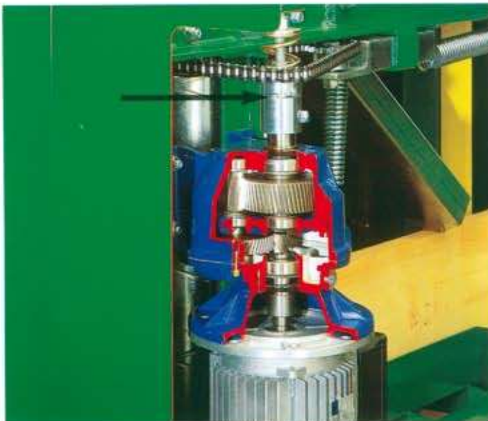
Junta de seguridad del motorreductor coaxial, en versión trifásica.
