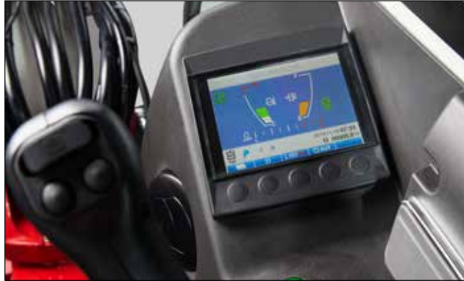
Panel de gran visibilidad con elementos de control visuales y acústicos. Modo ECO para aumentar la rentabilidad y disminuir el consumo de gasoil.
