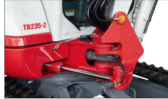
Robusto bloque de giro con latiguillos especialmente protegidos y giro hidráulico de brazo.
