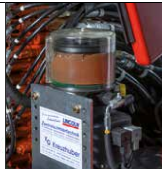
Engrase centralizado con dosificación controlada y aviso de nivel bajo de grasa
