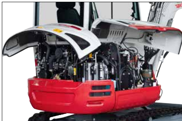
Amplias tapas abatibles para facilitar un acceso cómodo para dar mantenimiento al motor y a los componentes hidráulicos.
