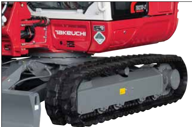
Rodillos con guía interior y exterior para un funcionamiento seguro de las cadenas de goma Double-Short-Pitch para una marcha baja en vibraciones.
