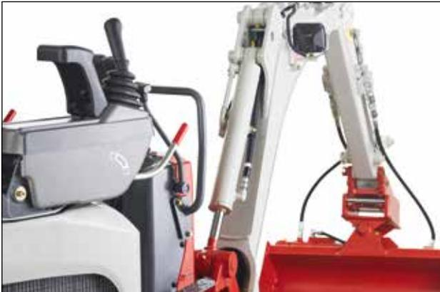
Botella de elevación en la parte posterior del brazo lo que proporciona una óptima protección contra daños.
